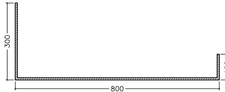
**ARMATURA: FERRO DA COSTRUZIONE DI DIAMETRO 8 MM**
