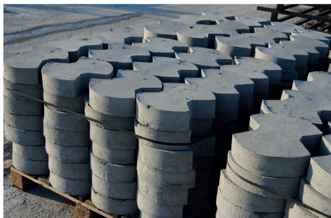
BLOCCO IN CEMENTO PER TIRANTE MEDIO-OVALE
